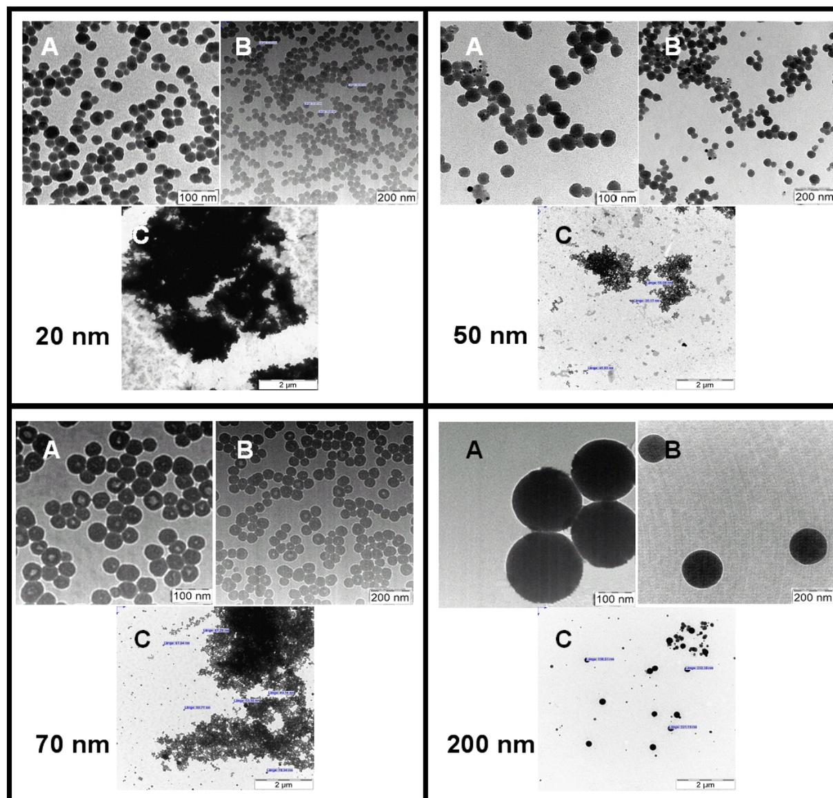
Abbildung 14: Transmissionselektronenmikroskopische Aufnahmen der Silica Partikel. (A) und (B) = Silica in  $\text{H}_2\text{O}$ , (C) = Silica in Medium. (A) Vergrößerung 85.000x, (B) Vergrößerung 50.000x, (C) Vergrößerung 7.000x
