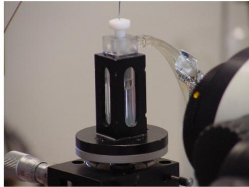
**Abbildung 4-6: Temperierbare Küvette im verwendeten Laboraufbau**
