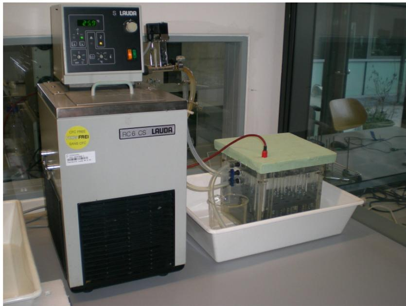
**Abbildung 4-13: Wasserbad mit externer Temperaturregelung samt Proberöhrchen mizellarer ATPS zur experimentellen Bestimmung des Gleichgewichts der Phasenseparation**
