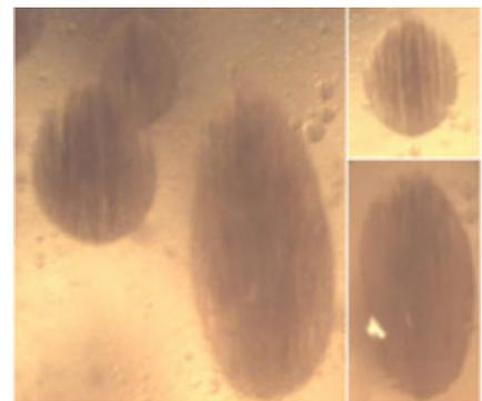
**Abbildung 5-13:** Zu Ellipsoiden verformte MEP-Tropfen;  $d \approx 100 \mu\text{m}$
