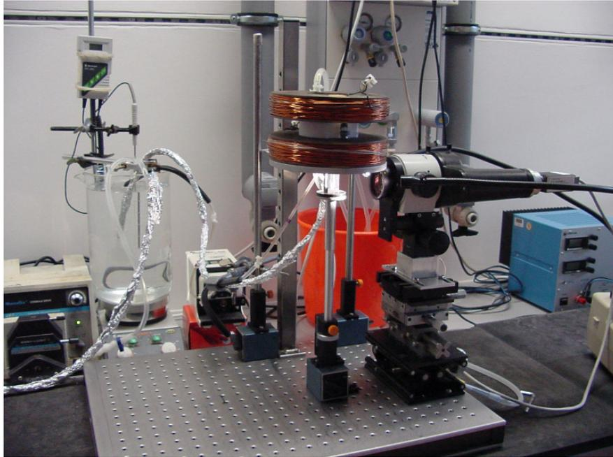
**Abbildung 4-7: Fotografie des verwendeten Laboraufbaus mit temperierbarer Küvette, Magnetfeldquelle, Mikroskop und Kamera**
