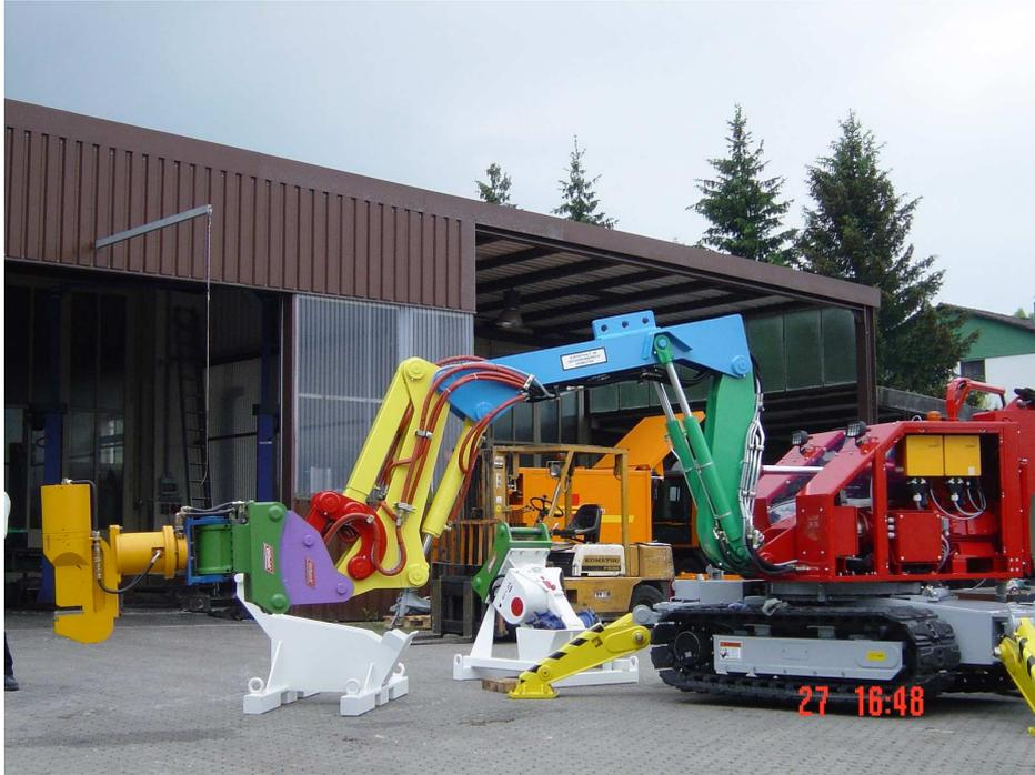
Abbildung B.3: Fernbedienbarer Bagger mit Nibbler (WAK)
