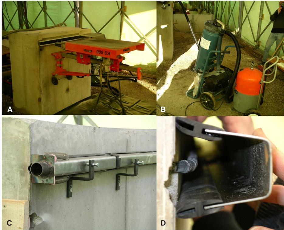
**Abbildung 7.4:** Bild des Saugversuches am TMB (A = Kompakte Seilsägeanlage, B = Staubabsauganlage, C / D = Abgedichtete Schnittfuge mit Moosgummi)
