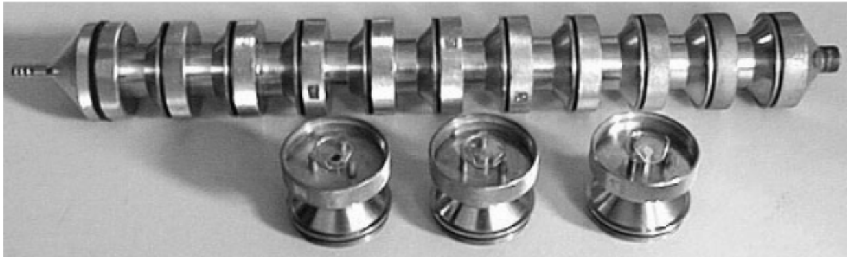
Abbildung 4.6: Beispiel eines Bayer-Kaskadenimpaktors [11].
