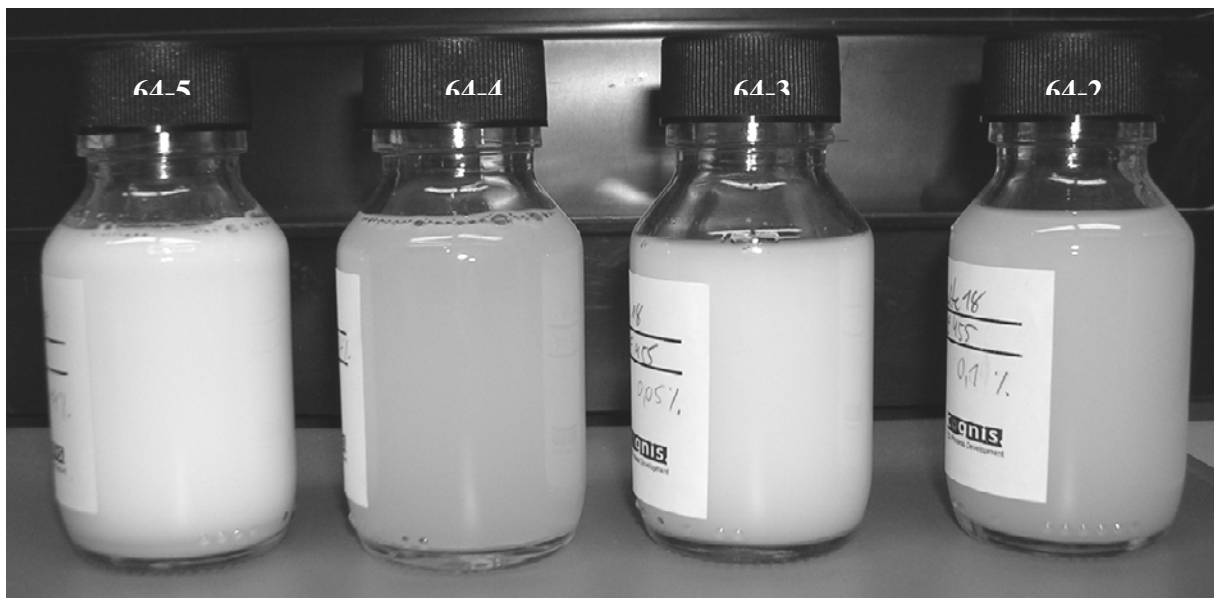
Abbildung A.27: Die in Versuch 64 hergestellten Betriebswassersuspensionen mit Lanette® 18-Partikeln, von links nach rechts: mit 0,014% Texapon N70, mit 0,07% Texapon N70, mit 0,05% Eumulgin HRE 455, mit 0,1% Eumulgin HRE 455.
