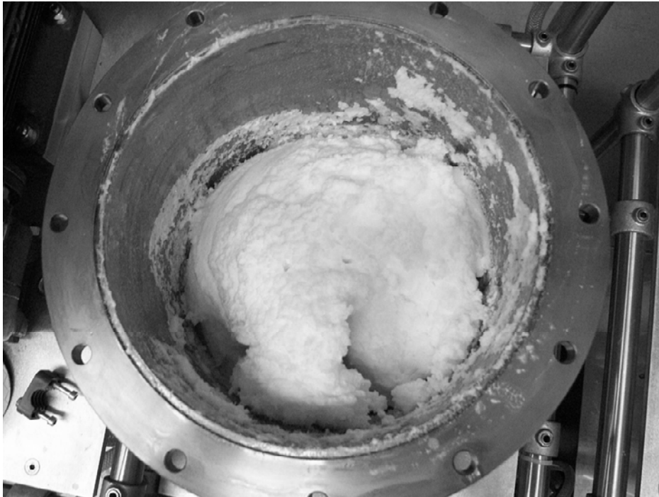
Abbildung A.16: Blick von oben in den geöffneten Abscheider: Lanette ® 16-Schaum, der zum Versuchsende nach Ablassen des Betriebswassers zurückbleibt.
