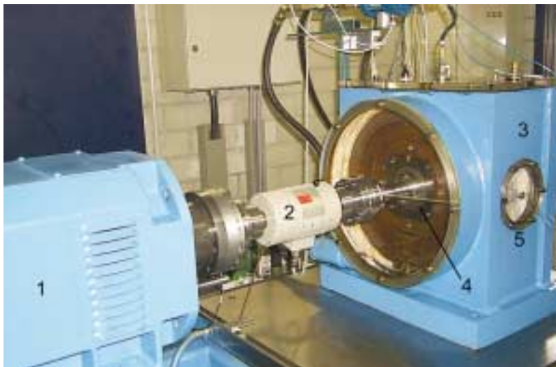
Bild 9: Großer Lagerprüfstand 1: Elektromotor; 2: Drehmomentmeßwelle; 3: Prüfstandsgehäuse; 4: Stützlager; 5: Fenster zur Opazitätsbeobachtung Figure 9: Large bearing test bench 1: Motor; 2: torque measuring shaft; 3: Test bench housing; 4: Support bearing; 5: Window for opacity observation
