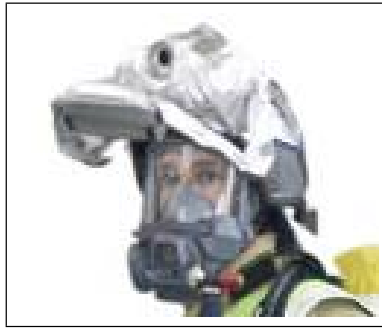
Abbildung 3. Helm montierte Wärmebildkamera der EADS - Werksfeuerwehr.
