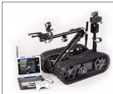
Abbildung 1. Roboter TALON der Firma Foster-Miller. Er kann per „plug and play“ mit bis zu sieben Sensoren bestückt werden.
