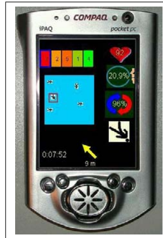
Abbildung 8. Zukünftiges LVS-Gerät wie es im A-Life Projekt eingesetzt wird, das neben der Position auch die relative Lage und den Vitalzustand der verschütteten Person anzeigt.
