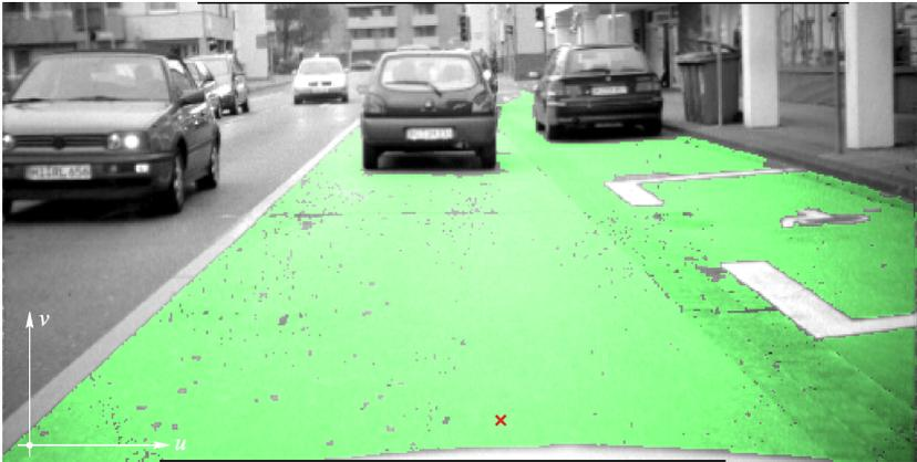
**Abbildung 2.6:** Regionenbasierte Segmentierung der Fahrbahnoberfläche aus Abbildung 2.5. Angenommen wird, dass der Bildbereich direkt vor dem Fahrzeug (symbolisiert durch das rote Kreuz) zur Oberfläche gehört. Ausgehend von dieser Position wird rekursiv nach benachbarten Bildpunkten gesucht, die ähnliche Helligkeitswerte besitzen.
