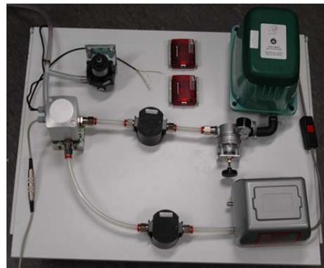
(d) Kompressoren, Wandler und Proportionaldruckregelventil.
