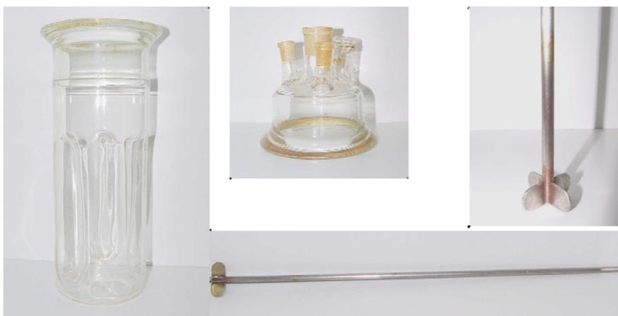
**Abbildung 3-2: Detailsansicht des Versuchsreaktors und des 4-Blatt-Rührers**
