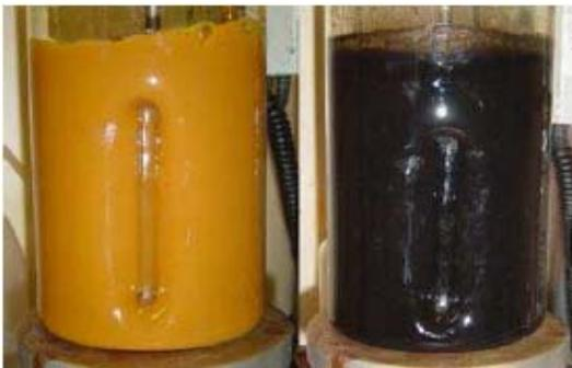
**Abbildung 3-3: Eisensalzlösung vor (links) und nach (rechts) der Fällungsreaktion**
