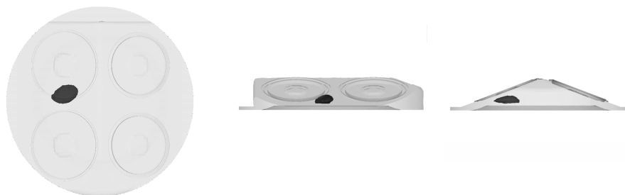
Abbildung 4-4: Mittels CFD-Simulation berechneter Zündherd, n_{\text{Mot}}=2000 \text{ min}^{-1} , p_{\text{mi}}=2,3 \text{ bar} , EB=380^\circ\text{KW v. ZOT} .
