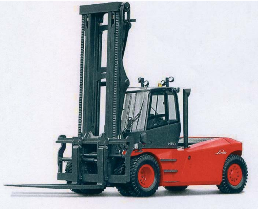
1: Linde-Dieselloßstapler mit Hydrostatik-antrieb in der Tragklasse von 10 bis 18t
