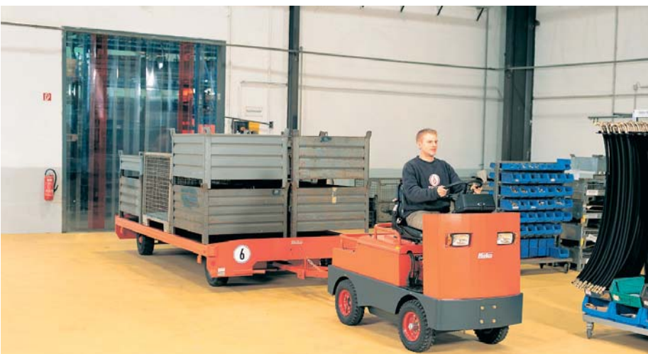
10: Vierrad-Elektroschlepper Hako-Scherpa S5 mit einer Zugkraft von bis zu 5.000 kg
