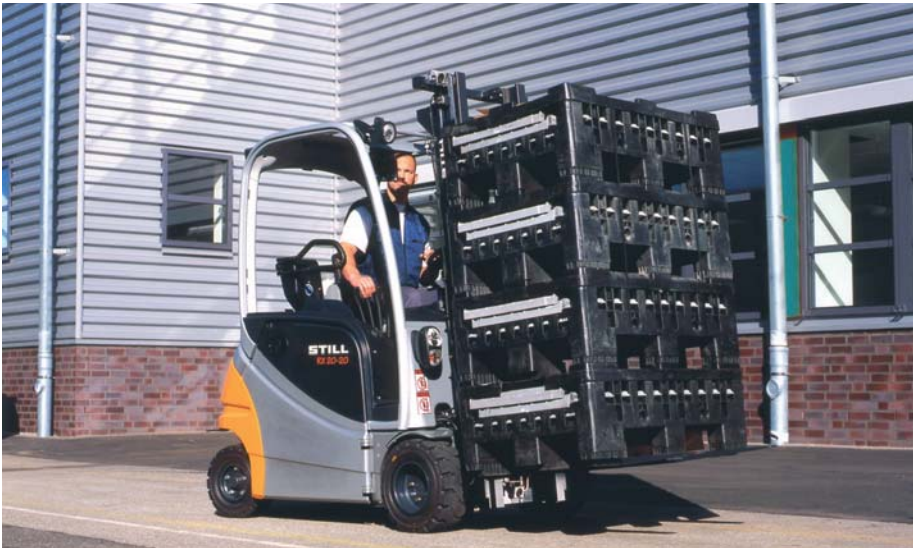
4: Still R20-20 kann mit dem derzeitigen Kamera-Monitor-System trotz großvolumiger Lasten vorwärts fahren
