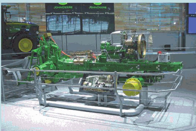
2: E-Premium-Modell von John Deere weist erstmals ein integriertes System zur Erzeugung und Verteilung hoher elektrischer Leistung (20 kW) auf
