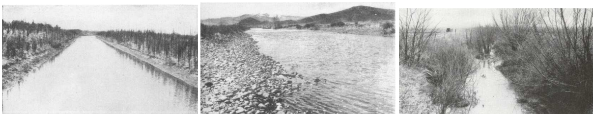
(a) k_{St} = 50 \text{ m}^{1/3}/s , Betonkanal mit grober Oberfläche (b) k_{St} = 36 \text{ m}^{1/3}/s , Fluss mit Kies- und Sandsohle (c) k_{St} = 12 \text{ m}^{1/3}/s , stark verwachsenes Bachbett
