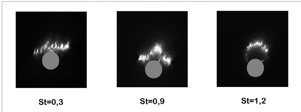
Abb.4.4-8 Ansichten im Querschnitt;  $d_p=1,3 \mu\text{m}$ ;  $d_F=30 \mu\text{m}$ ;  $R=0,04$ .
