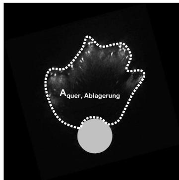
Abb.3.5-7 Bildanalyse zur Bestimmung der Querschnittsfläche der Ablagerungen und damit deren Volumina.
