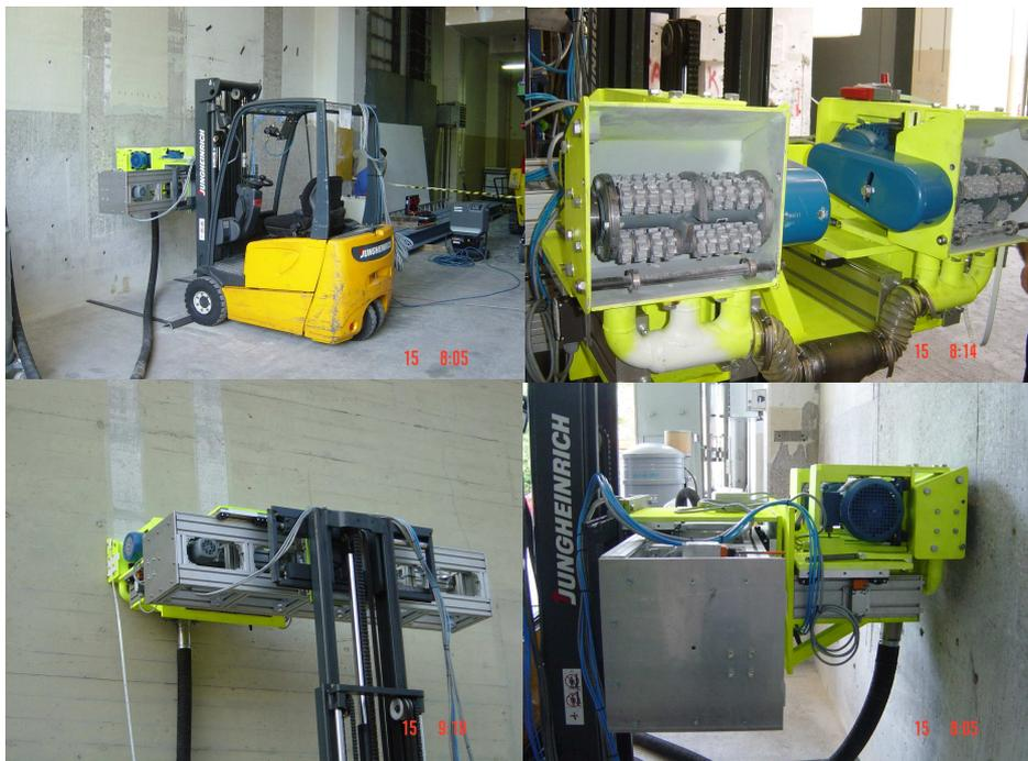
Abbildung B.4: Wandshaver mit Absaugung am Stapler (WAK)
