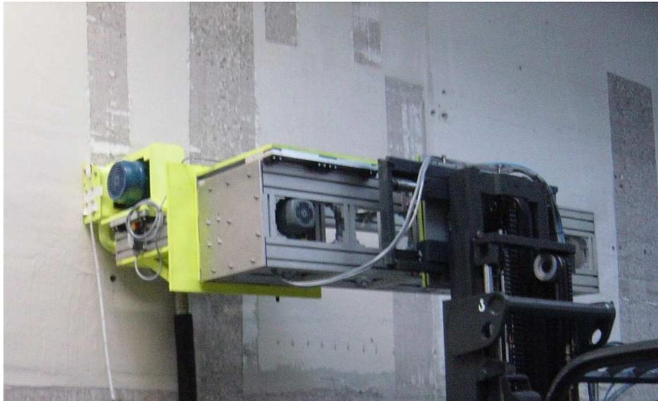
**Abbildung 7.1:** Oberflächendekontamination mit einem Wandshaver-Stapler-System [Quelle: WAK]
