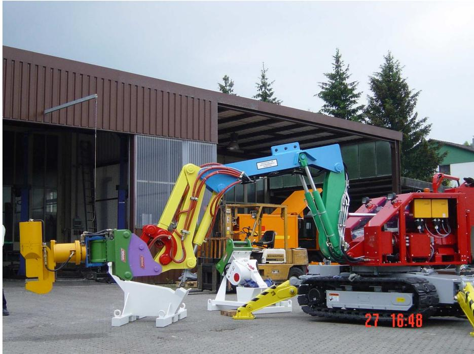
Abbildung B.3: Fernbedienbarer Bagger mit Nibbler (WAK)
