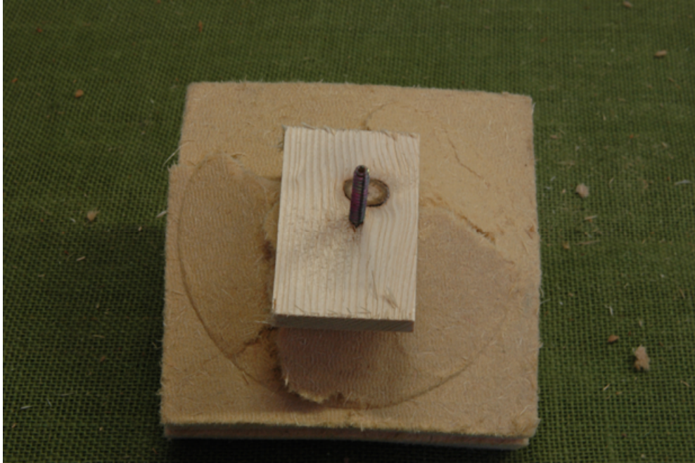
Bild 6-12 Anordnung einer Holzprobe für ein realitätsnahes Einziehen des Kunststofftellers in die HFDP
