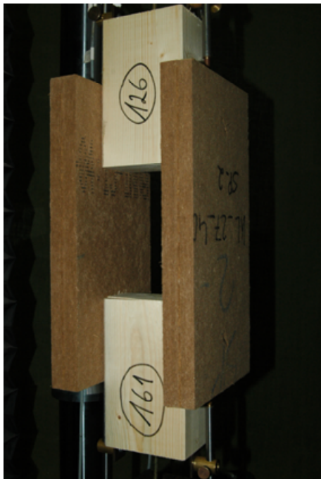
Bild 7-27 Zugscherkörper einer Holz-HFDP-Verbindung mit Breitrückenklammern
