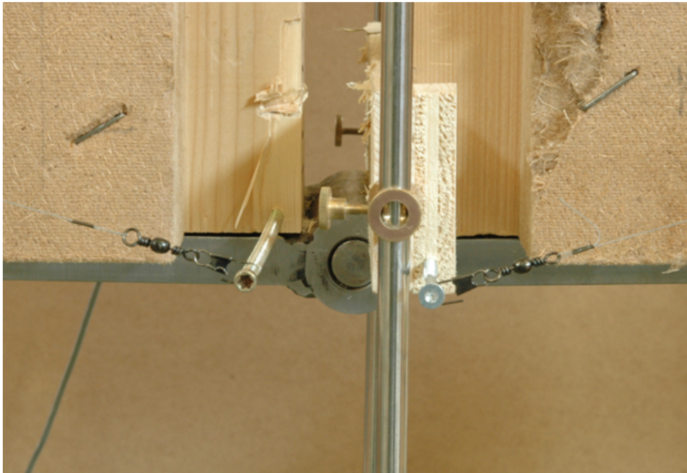
Bild 12-19 Zugstoßgelenk zur Verbindung der beiden Versuchskörper
