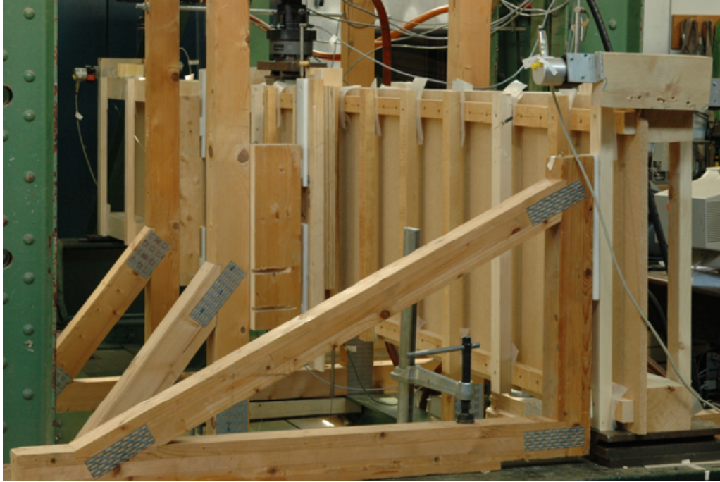
Bild 8-14 Versuchsaufbau der Dachscheibenversuche
