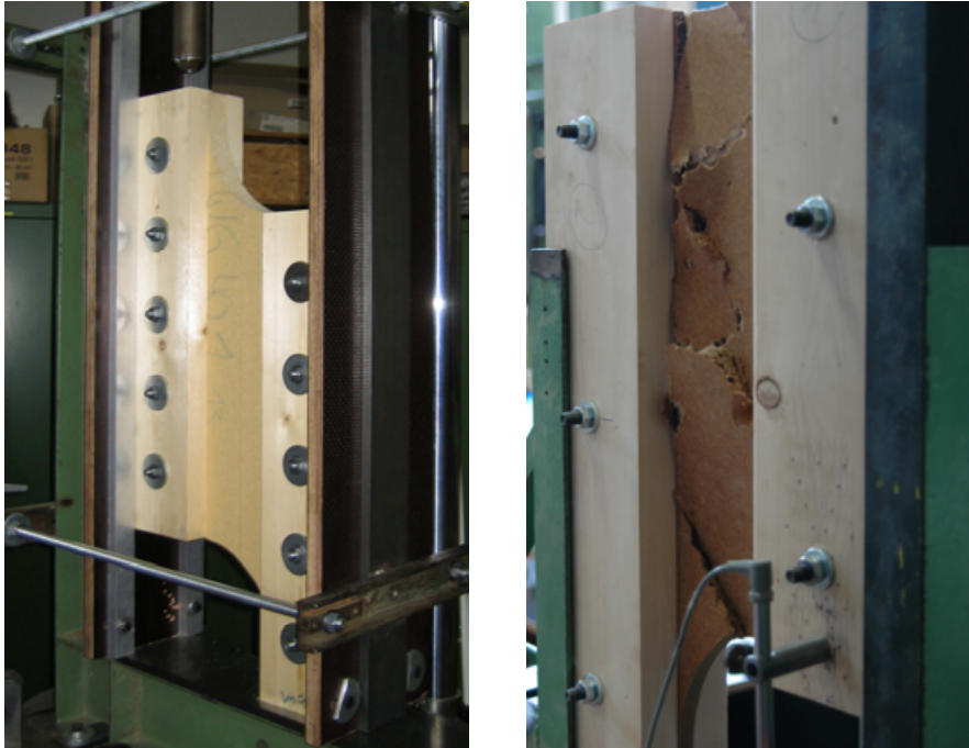
Bild 4-4 Eingebauter Versuchskörper und Versagen in der Schubzone
