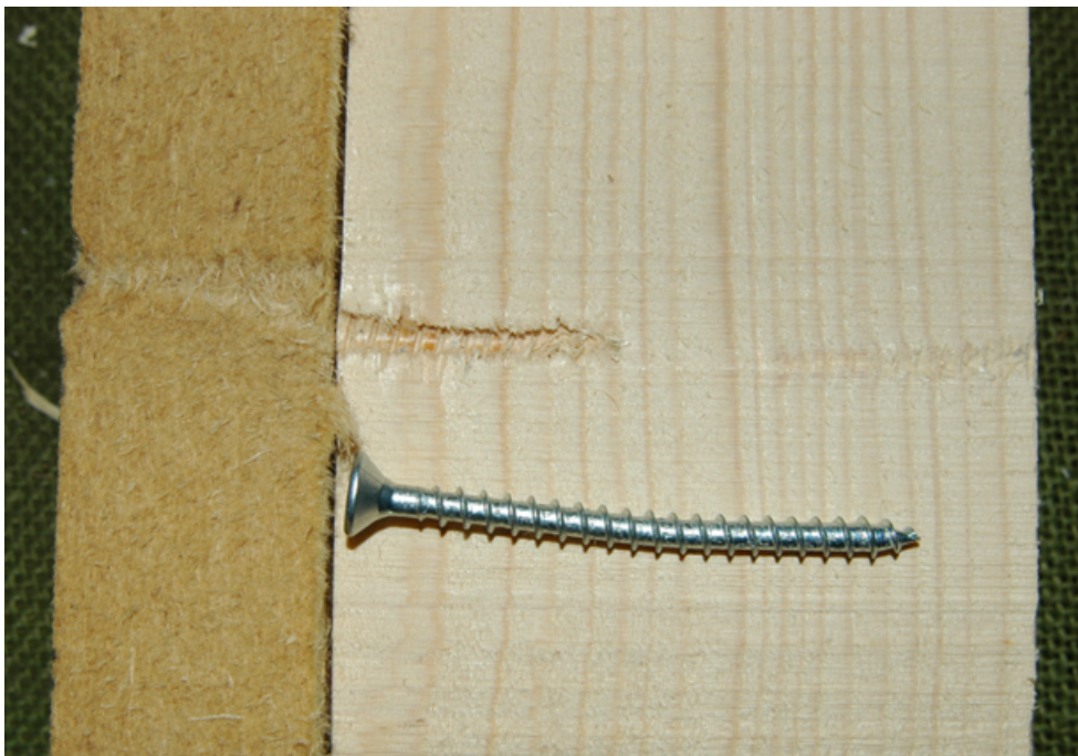
Bild 7-6 Geöffneter Druckscherkörper einer Holz-HFDP-Verbindung mit einer Schraube (Würth ASSY II 6 x 80 mm) und UDP 1_1d_I
