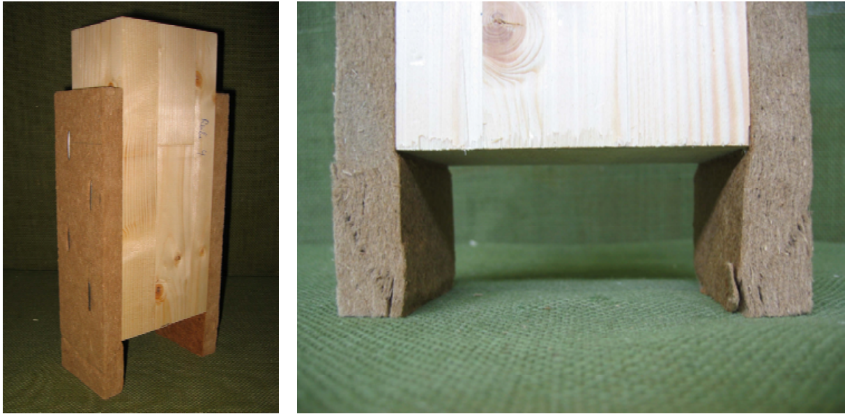
Bild 7-2 Druckscherkörper mit Breitückenklammern nach DIN EN 1381:2000; Erreichen der Druckfestigkeit der Holzfaserdämmplatte
