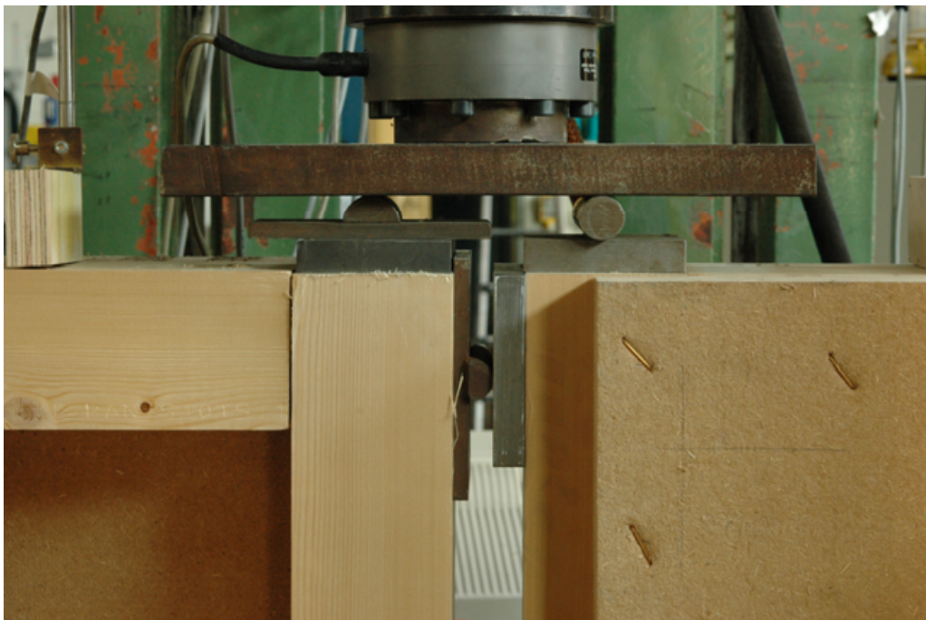
Bild 12-18 Symmetrische Lasteinleitung in die Rähme
