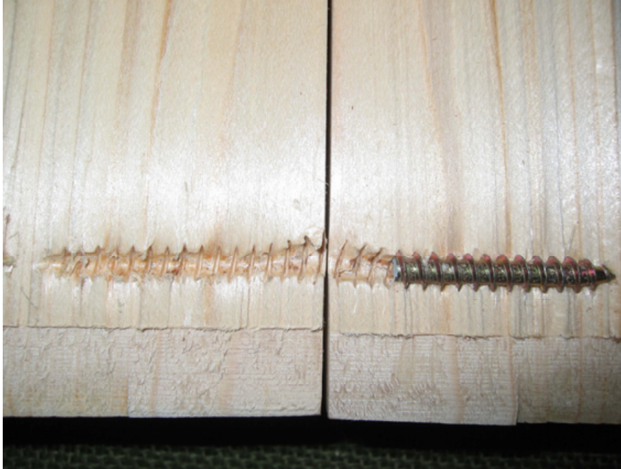
Bild 7-5 Geöffneter Druckscherkörper einer Holz-HFDP-Verbindung mit einer speziellen Schraube und UDP 3_d_I
