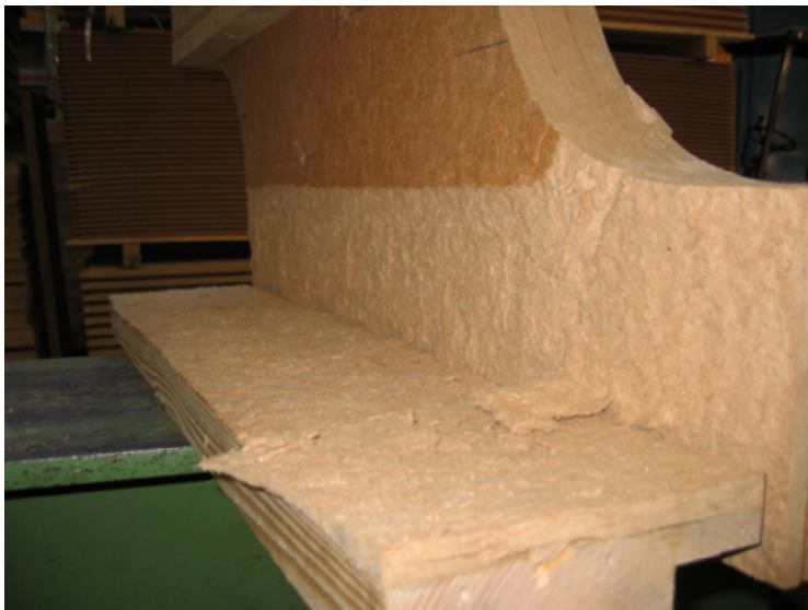
Bild 4-3 Schubversagen in Plattenebene im geklebten Versuchskörper
