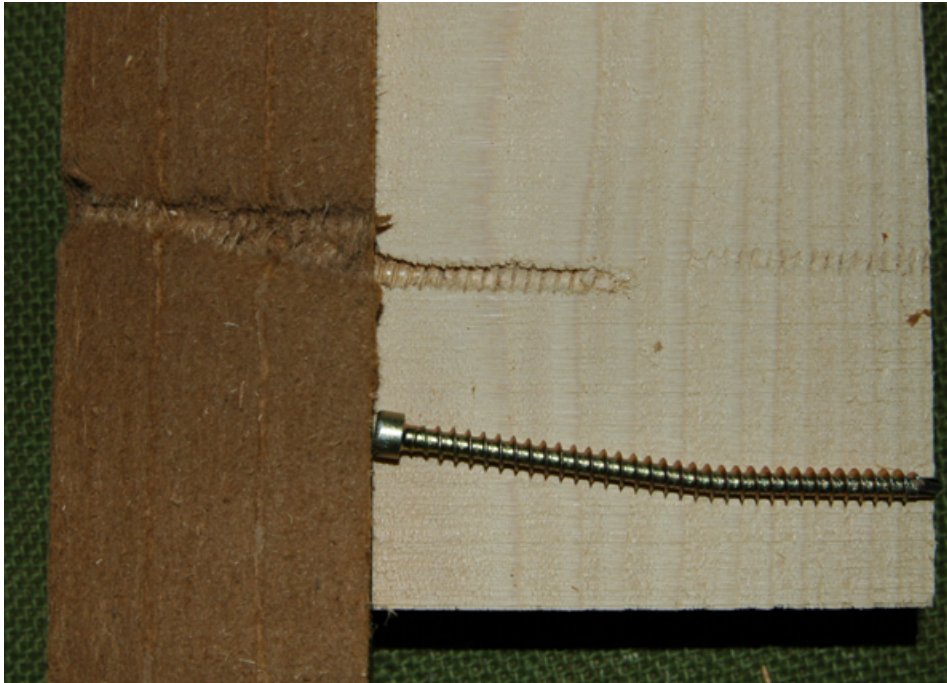
Bild 7-7 Geöffneter Druckscherkörper einer Holz-HFDP-Verbindung mit einer Schraube (Würth ASSY VG 6 x 100 mm) und UDP 3_d_I
