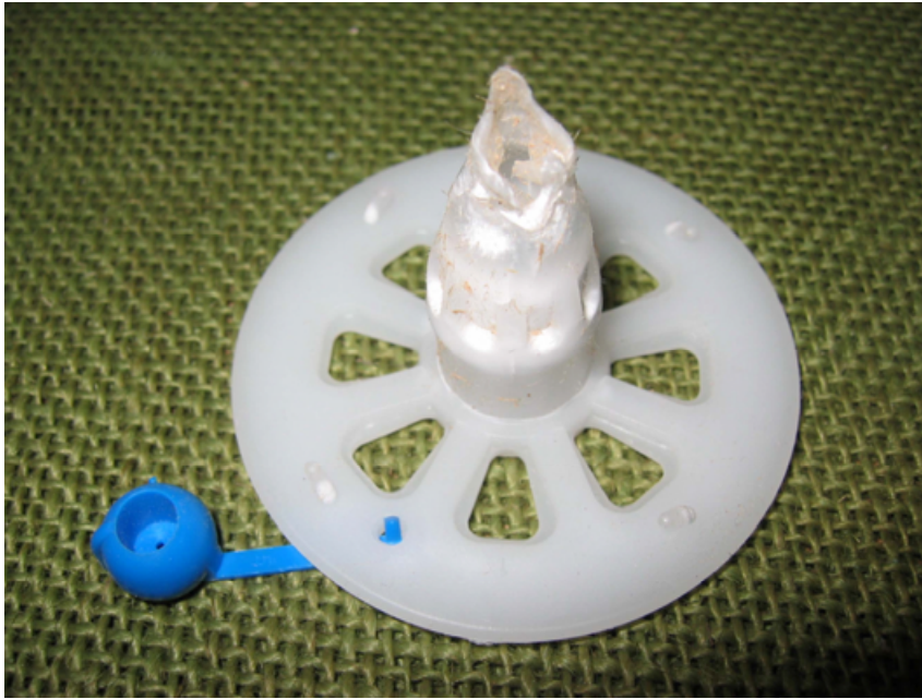
Bild 6-11 Typisches Versagen der speziellen Schraube – Durchziehen der Schraube durch den Kunststoffteller
