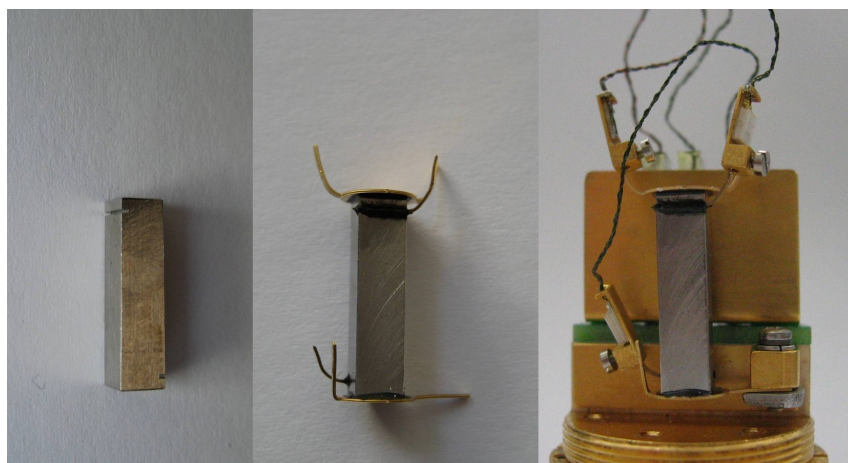
Abbildung 30: Edelstahl Probe: vor der Befestigung der Kupfer-Zuleitungen, danach und montiert auf dem Probenhalter.
