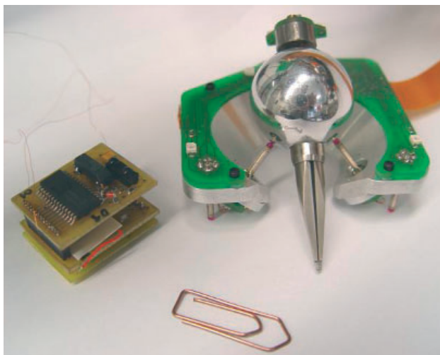
Mikroroboter- Prototypen im Größenvergleich: Miniman 3-2 (rechts) und ein erster, von der EPFL Lausanne gefertigter MiCRoN- Prototyp (links)
