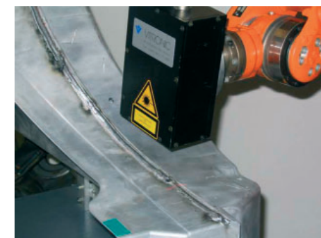
Roboter-gestützte Inspektion einer Schweißnaht
