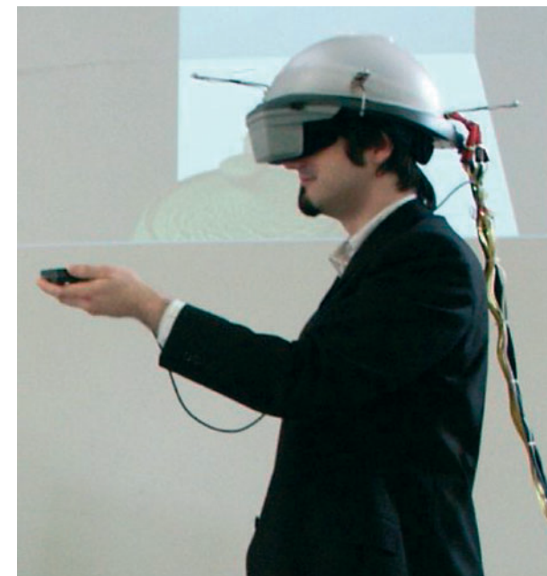
Mit Mikrofonen versehene Hochauflösendes Stereo Head-Mounted- Display und Hand- Tracking-Einheit
