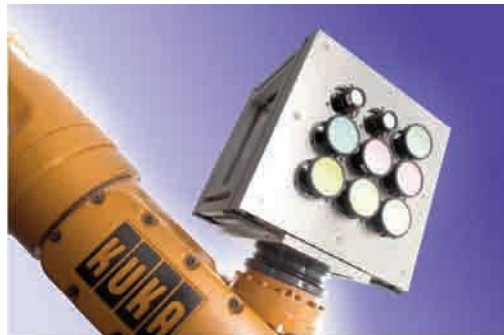
Bild links: Tiefenrekonstruktion durch Fusion der Spektral- und Stereoserie. Nähere Regionen werden dunkler dargestellt. Bild rechts: Kamera-Array mit Spektralfiltern
