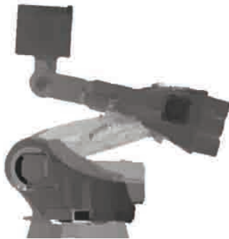
Bild links: Tiefenrekonstruktion durch Fusion der Spektral- und Stereoserie. Nähere Regionen werden dunkler dargestellt. Bild rechts: Kamera-Array mit Spektralfiltern
