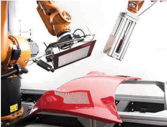
Robotergeführter Sensorkopf bei der Inspektion eines Karosserieteils.
