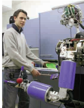
Multimodale Mensch-Maschine-Kommunikation mit dem humanoiden Roboter ARMAR-IIIa.
