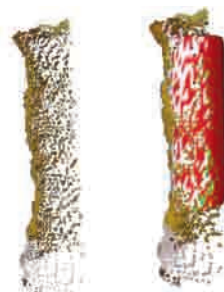
Bild rechts: Punktwolke und geschätzte Superquadrík
