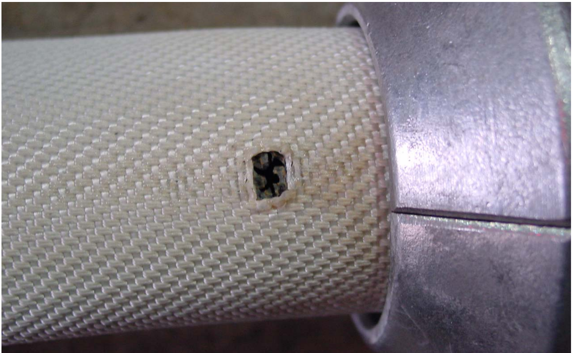
Bild 28: Das Schadensbild eines DLS (E = 4) führenden Schlauches bei 300°C Umgebungstemperatur und einem Schließdruck von 9,7 bar, Versagenszeitpunkt: 10,5 min nach dem Schließen des Strahlrohres
