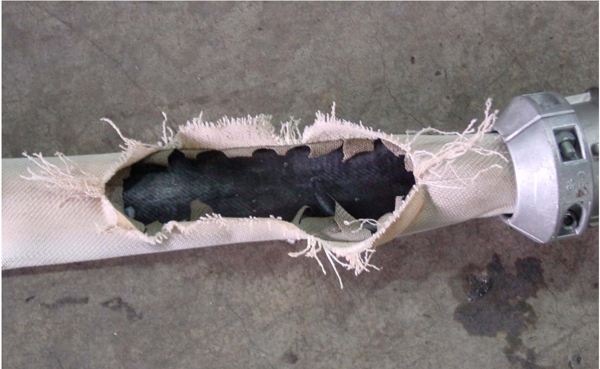
Bild 28: Das Schadensbild eines DLS (E = 4) führenden Schlauches bei 300°C Umgebungstemperatur und einem Schließdruck von 9,7 bar, Versagenszeitpunkt: 10,5 min nach dem Schließen des Strahlrohres
