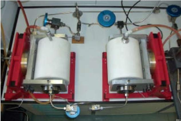
Abb. 6 Apparatur zur Untersuchung des Einflusses von Hochdruck gesteuerter thermischer Behandlung auf Sojamilch-Isoflavone. Simulation adiabatischer Effekte im Labormaßstab.
