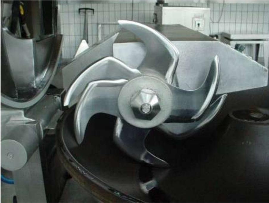
Abb. 4: 120 L- Kutter: Messergeometrie und Aufstellung der Messer. 6- Messerkopf
