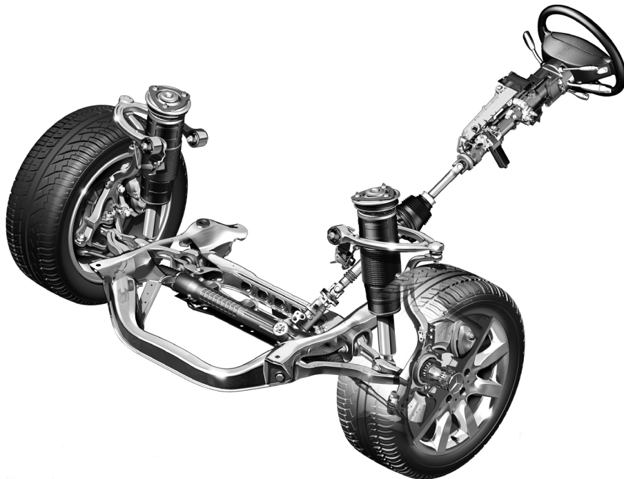
Abb. 2.6: Eine Pkw-Vorderachse mit Rad-Reifen-Verbund, Radaufhängungslenkern, Feder-Dämpferbein, Fahrschemel und Lenkstrang.
