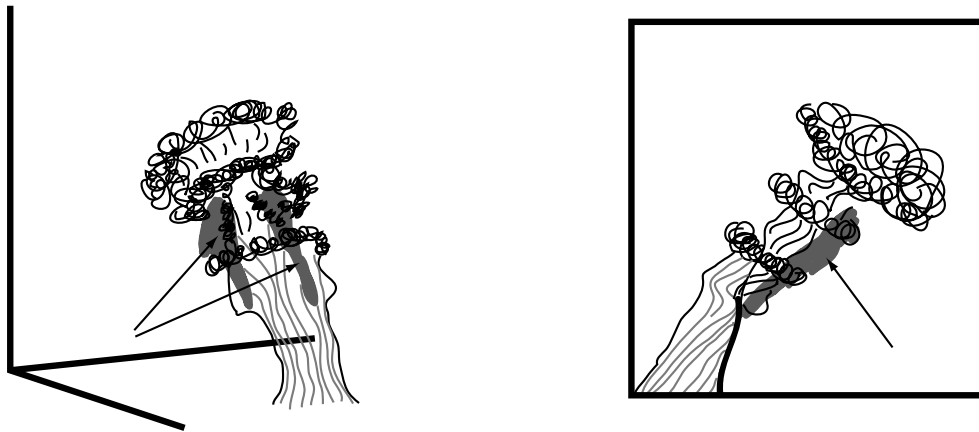
Abbildung 3.7: Skizzierte Darstellung des Strahls in Querströmung nach CORTELEZZI & KARAGOZIAN 2001. Die skizzierten grauen Isoflächen der Wirbelstärke, welche zusätzlich mit Pfeilen markiert sind, spiegeln die Kerne des gegensinnig rotierenden Wirbelpaares wieder. (nach CORTELEZZI & KARAGOZIAN 2001 [32])
