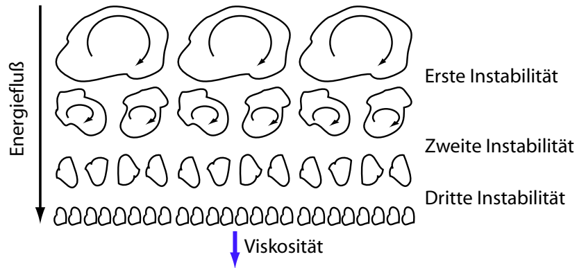
(a) Schematische Darstellung der Energiekaskade (nach Frisch)
