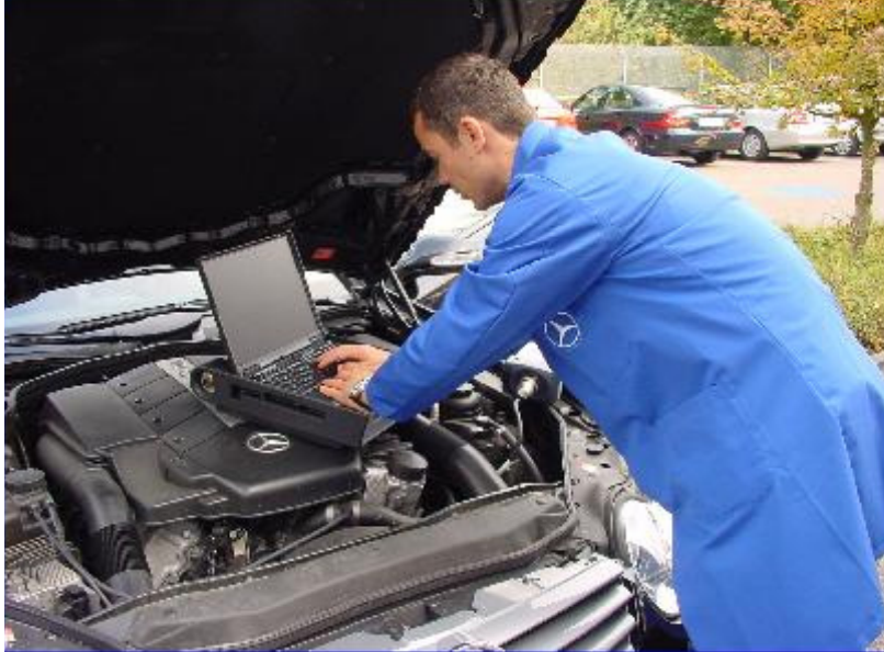
Abbildung 2-8 Offboard-Diagnose - Techniker mit Diagnosegerät
