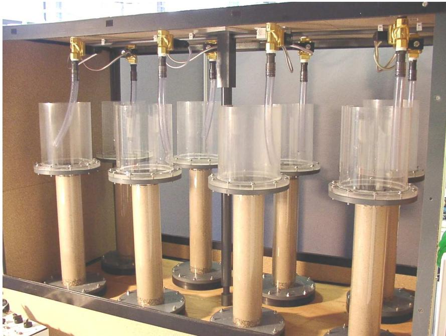
Abb. 4-2: Säulenversuchsstand mit 8 Versuchssäulen nach Modifizierung in Versuchsreihe 2.
