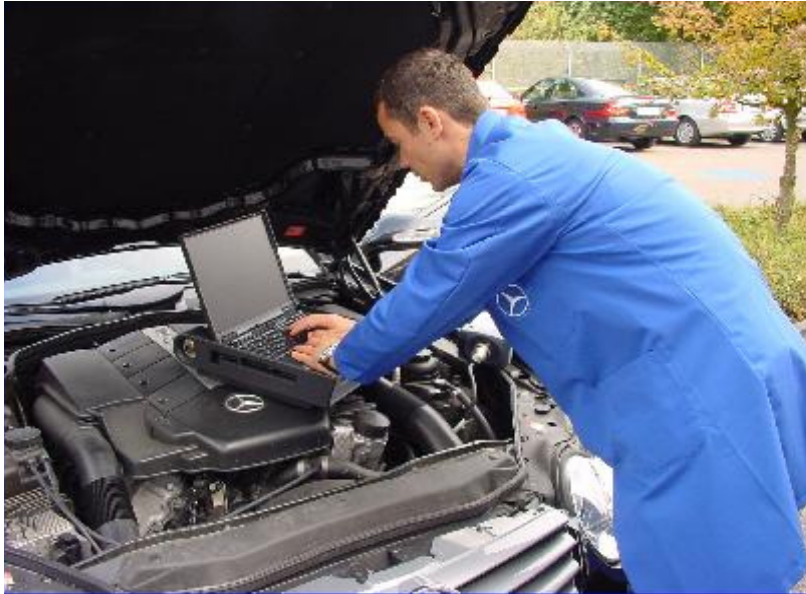
Abbildung 2-8 Offboard-Diagnose - Techniker mit Diagnosegerät
