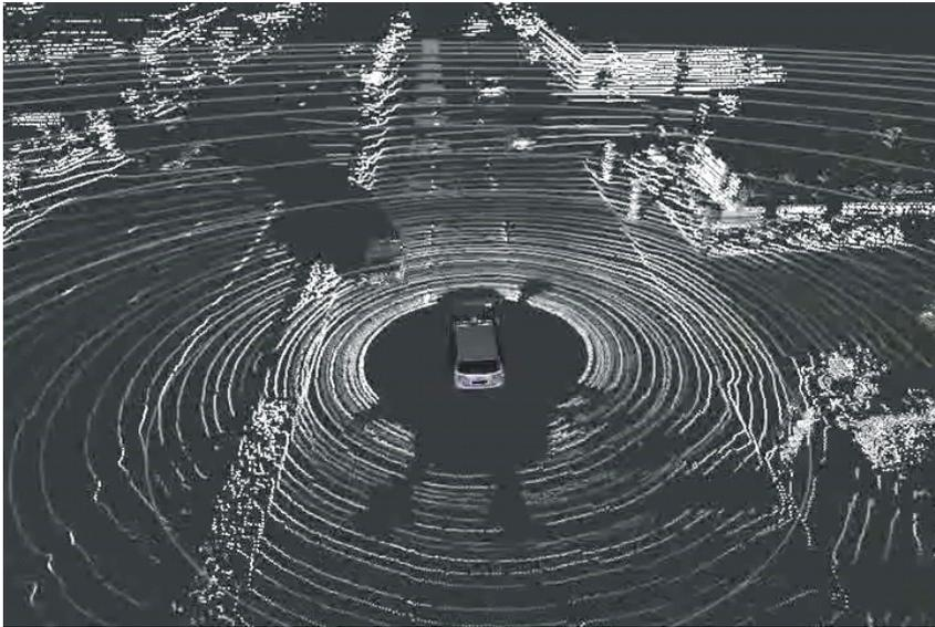
**Abb. 7:** Laserdaten zur Bestimmung der Objektkarte
