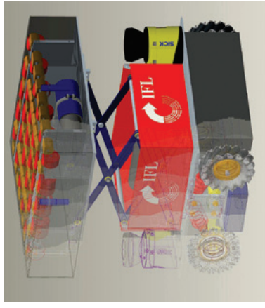
Abb. unten: Kleinskaliges Autonomes Redundantes Intralogistik System Karlsruhe-Element mit Hub
