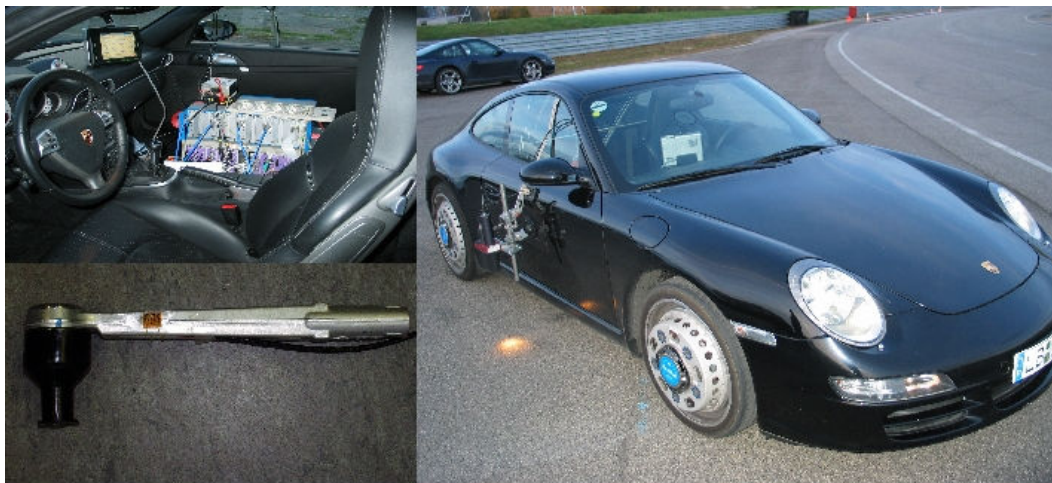
Bild 6.18: Messfahrzeug mit Kraftmessfelgen und -lenkern
