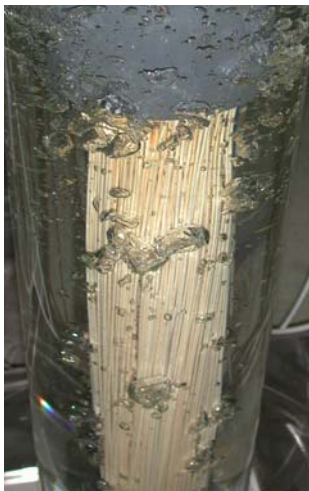
Abbildung IV-26: Bräunliche Verfärbung der Membran durch Einlagerung von NOM nach dem Adsorptionsversuch (Abbildung IV-25).
