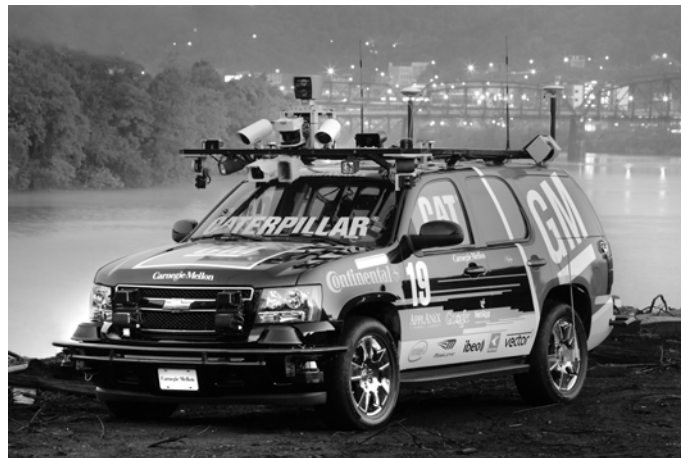
Abbildung 2.4: Versuchsfahrzeug Boss der Carnegie Mellon University, Gewinner der Urban Challenge 2007. Bildquelle: [Tartan Racing 08].
