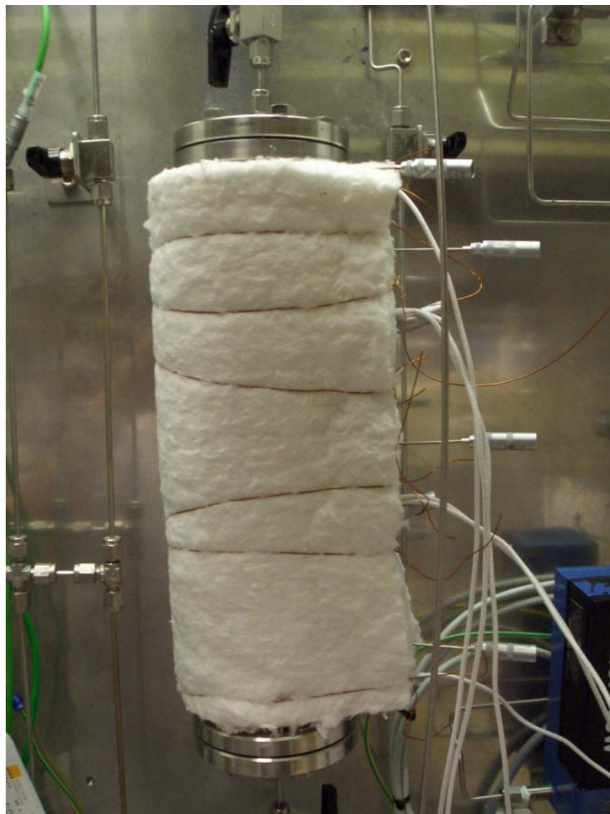
Abbildung 3: Reaktor der Laboranlage ohne Isolation der Flansche
