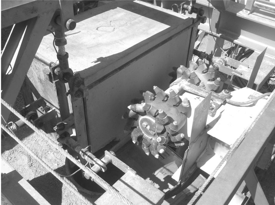
Abbildung B.3: Die Fräse TEREX|Schaeff WS 30 im Versuchsstand
