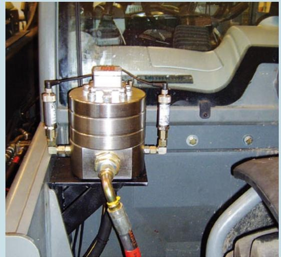
Volumenstromsensor im hydrostatischen Kreis des Fahrantriebes
