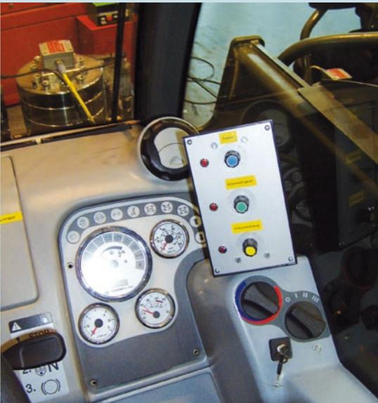
Im Cockpit installiertes Bediengeräte zur Aufzeichnung der Arbeitstätigkeit
