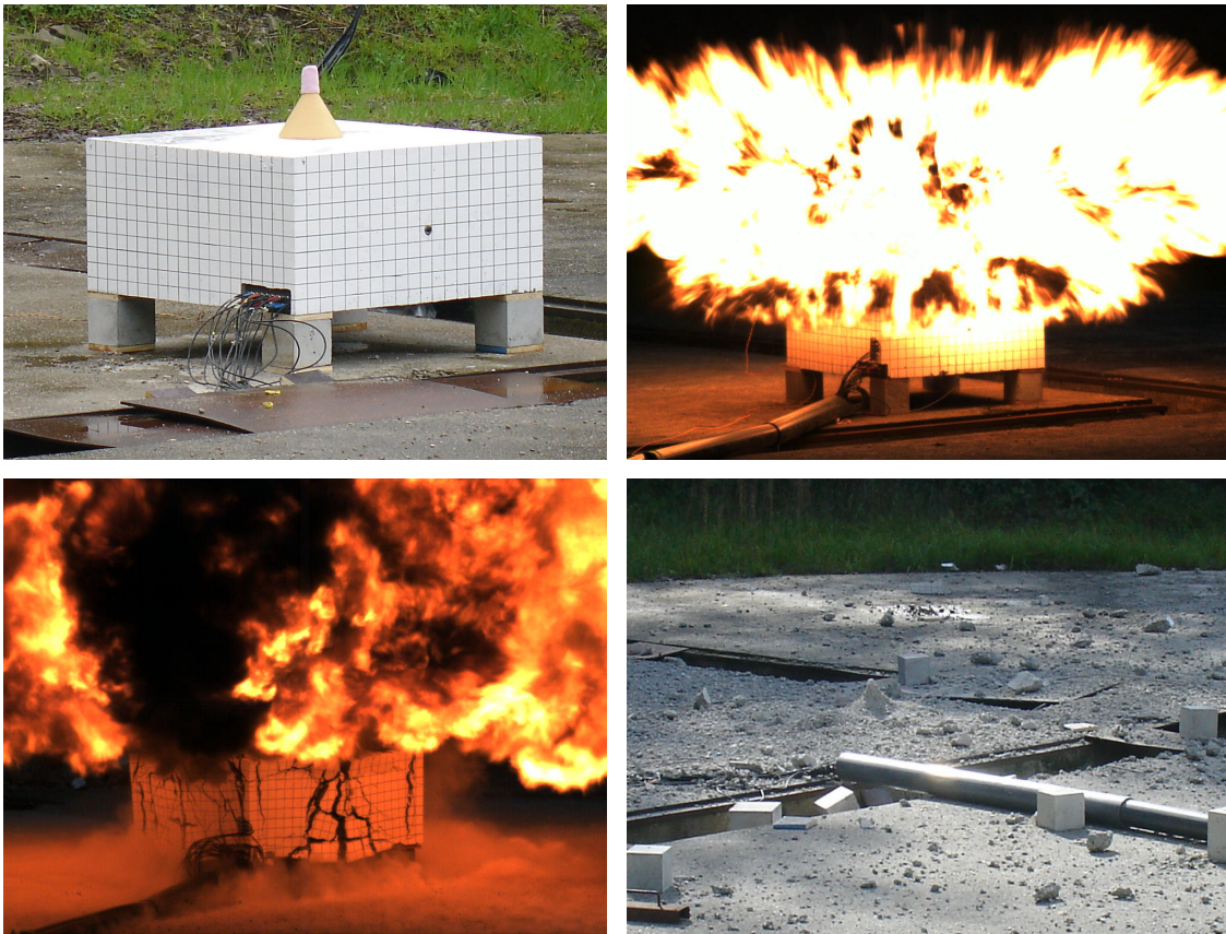
Bild 5.1: oberer Bildteil: (links) Versuchskörper (1,0 x 1,0 x 0,5 m) mit kegelförmiger Ladung (3325 g, \varnothing = 20 cm); (rechts) Versuchskörper 200 \mu s nach der Zündung; unterer Bildteil: (links) fortschreitende Zerstörung nach 750 \mu s; (rechts) Sprengergebnis
