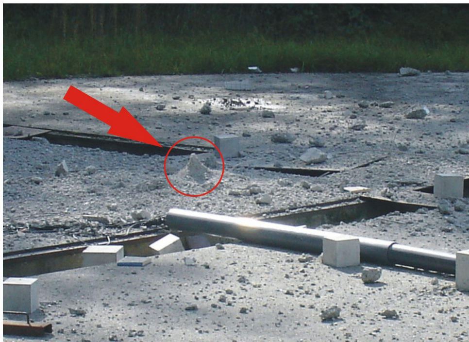
Bild 5.56: Vollständig zerstörter Versuchskörper nach Sprengung mit 3325 g - Ladung
