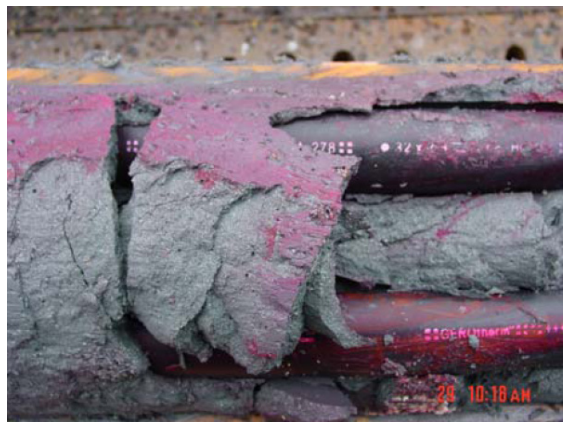
Abb. 2-10: Bilder der Modellversuche mit Farbtracern zur Kennzeichnung der Wegsamkeiten; Bild oben: Detail Grenzfläche Sondenrohr-Hinterfüllung, Bild unten: Wegsamkeiten entlang der Mantelfläche (AMT DER OÖ. LANDESREGIERUNG, GRUND- U. TRINKWASSERSCHUTZ 2007)
