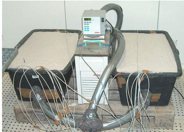
Abb. 3-9: Prüfstand Geothermie in der Klimakammer
