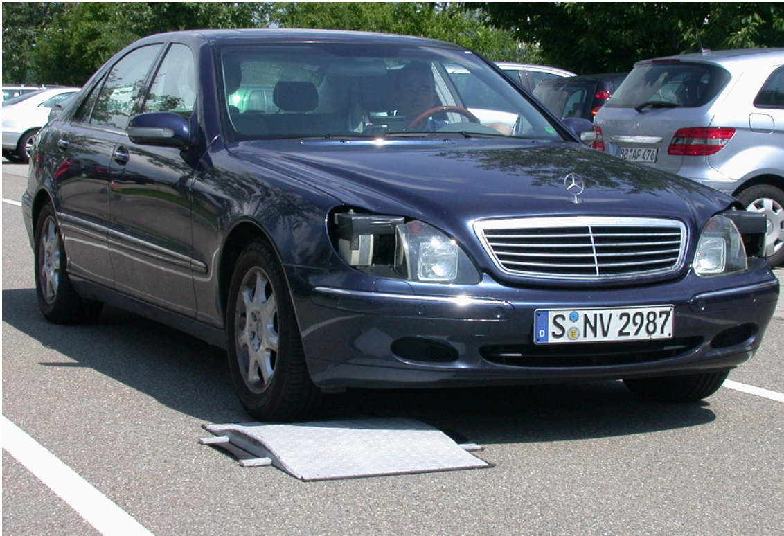
Abb. 3.17.: Versuchsfahrzeug mit LIDAR-Sensoren bei Überfahrt der Fahrbahnschwelle
