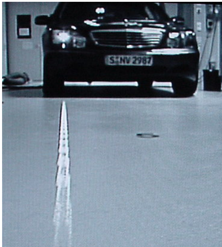
Abb. 6.2.: Bild des LIDAR-Meßstrahls, aufgenommen von einer Infrarotkamera
