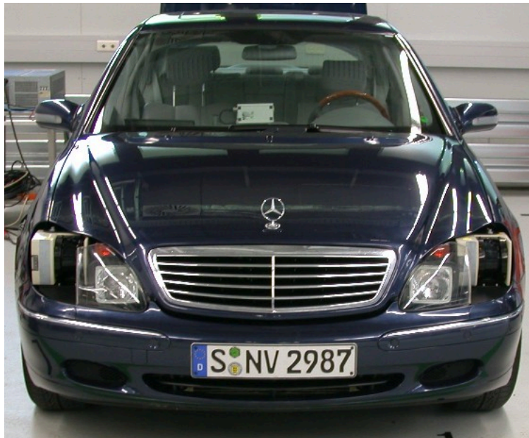
Abb. 6.1.: Frontansicht des Versuchsfahrzeugs mit integrierten LIDAR-Sensoren
