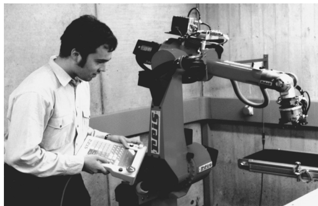
Abb. 5.5: Programmierung eines Industrieroboters mit dem Teach-in-Verfahren
