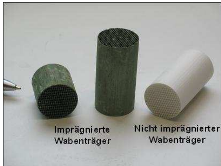
Abbildung 7.21: Wabenträger (Cordieritkeramik C520 der Firma Rauschert: Aluminium-Magnesium-Silikat-Basis mit einer max. Einsatztemperatur von 1200 °C); frisch imprägnierter Wabenträger: BET-spezifische Oberfläche A_S = 1,9 \text{ m}^2/\text{g} , Durchmesser d = 20 \text{ mm} , Länge L = 50 \text{ mm}
