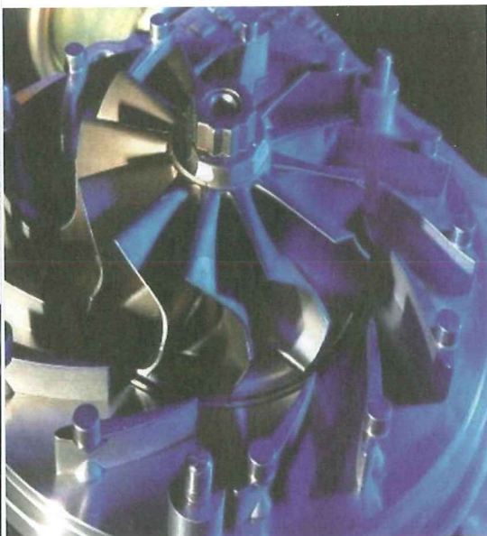
3: Turbolader mit verstellbaren Turbinenleitschaufeln
