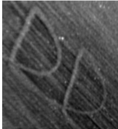
Bild 56: Abbildung der Modellstiftbewegung aufgrund abrasiver Verschleißpartikel
