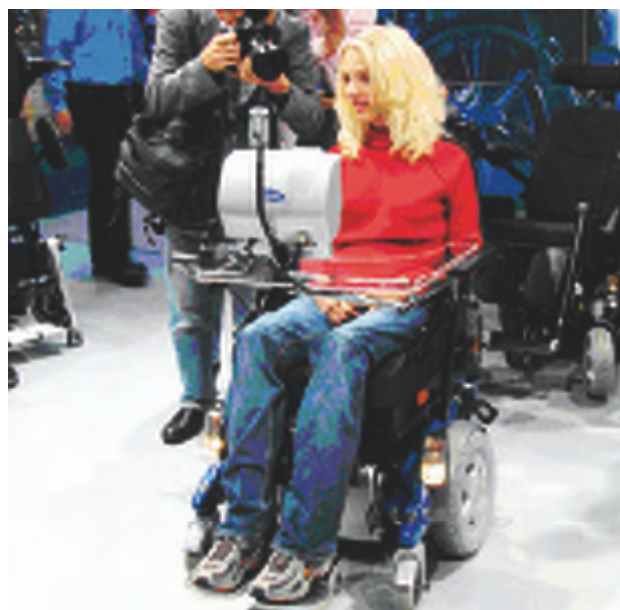
Abbildung 10: Über Mimikerfassung gesteuerter Rollstuhl.
