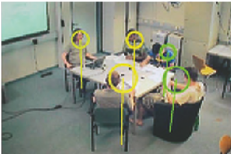
Abbildung 1: Mehrpersonentracking in einem Smart-Room. Für die Lokalisierung werden fünf Kameras genutzt. Außerdem können auch Mikrophone für eine zur Lokalisierung mit genutzt werden.
