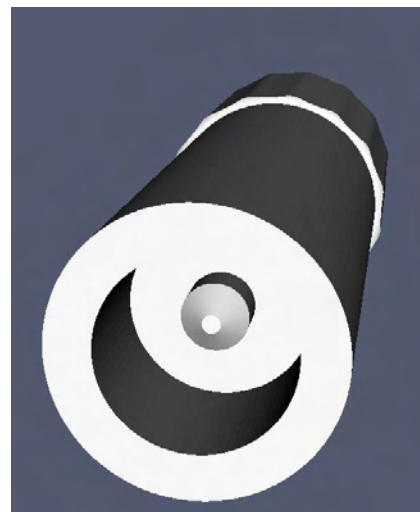
Abbildung A.3: Abstimmung von existierenden Markerschrauben und einer Messspitze zum intraoperativen Antasten der Markerschrauben. Links: Implantierte Markerschrauben in einem Felsenbeinpräparat. Rechts: CAD-Modell einer Messspitze für die links abgebildeten Markerschrauben.
