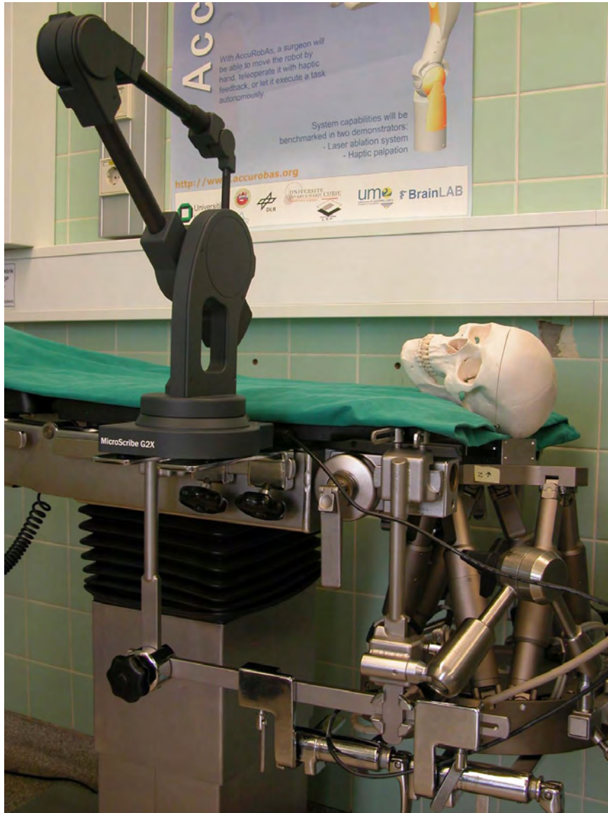
Abbildung 4.14: Integration der Hexapodplattform in den OP-Tisch zur mikrometeregenauen Positionierung der Knochenprobe unter dem Laserscankopf. Zusätzlich ist der verwendete Messarm erkennbar, welcher auf zwei Auslegern steht, die am OP-Tisch befestigt sind.
