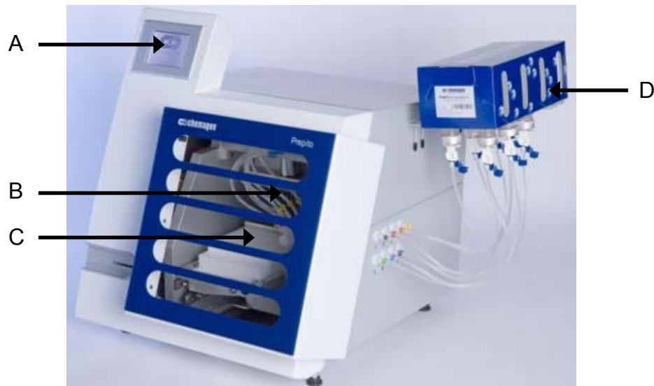
Abbildung 26: chemagic Prepito™ der Firma chemagen Biopolymer Technologie AG. A: Touchscreen zur Bedienung; B: Im Inneren, beweglicher Magnetseparator; C: Im Inneren, Mikrotiterplatte; D: Pufferreservoir zur Befüllung der Mikrotiterplatte.
