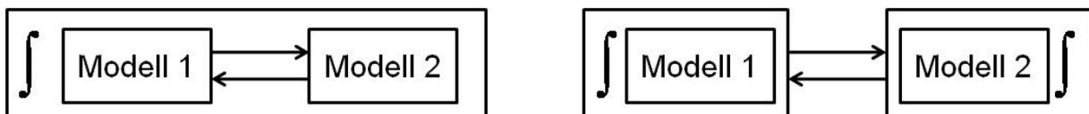
Abbildung 2.8: Prinzip der *tight coupling* (links) sowie der *weak coupling* (rechts) hinsichtlich der numerischen Integration<sup>57</sup>
