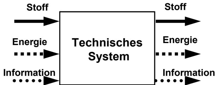
Abbildung 2.1: Technisches System als Black-Box mit Eingangs- und Ausgangsgrößen
