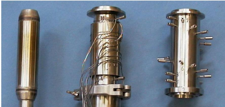
Abbildung 39: Foto (v.l.n.r.) des Innenzylinders, des beheizbaren Außenzylinders und des Außenzylinders mit Druckanbohrungen, wahlweise kombinierbar zum Aufbau der beiden eingesetzten Testeinsätze in Ringspaltgeometrie,  $R0.6/TX$  und  $R0.6/PX$ .
