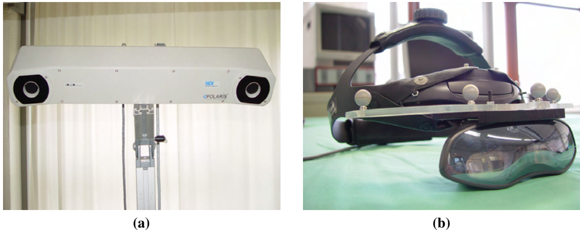
Abb. 4.5: (a) Polaris Trackingsystem. (b) Durchsichtbrille.
