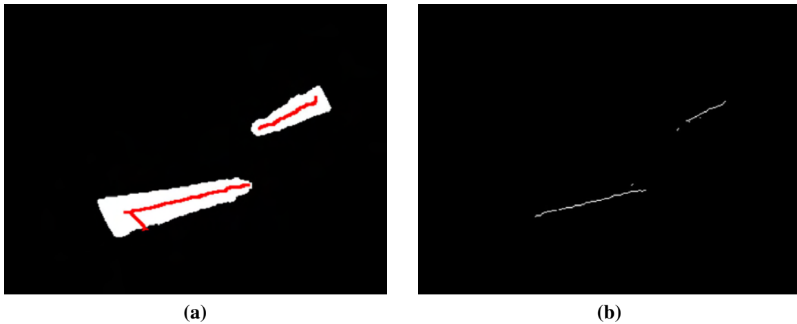
Abb. 6.19: Approximation der Instrumentenachse (a): Ergebnis der Skeletonisierung. (b) Ergebnis der Hough -Transformation.
