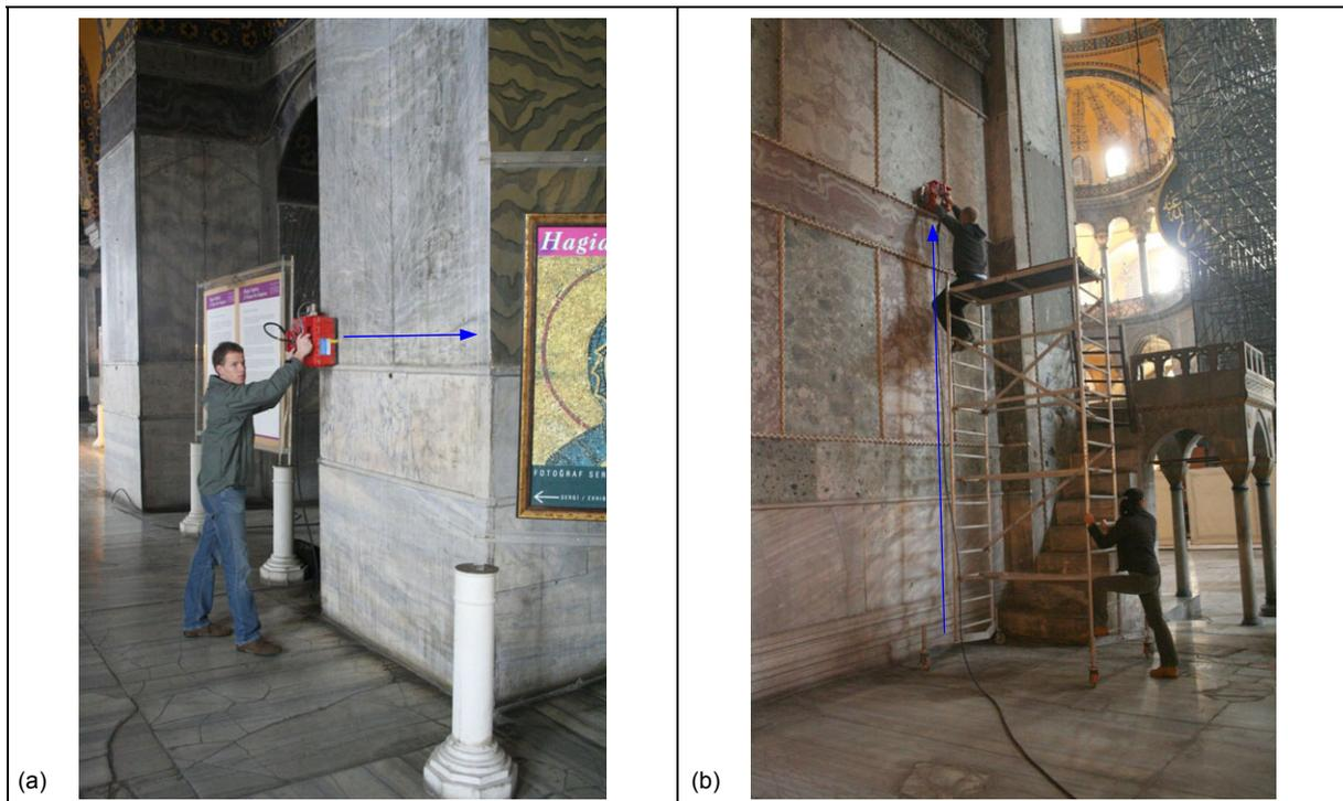
**Abb. 6.3:** Horizontale (a) und vertikale (b) Radarmessungen an den Hauptpfeilern in Grund- (b) und Gallerieebene (a)
