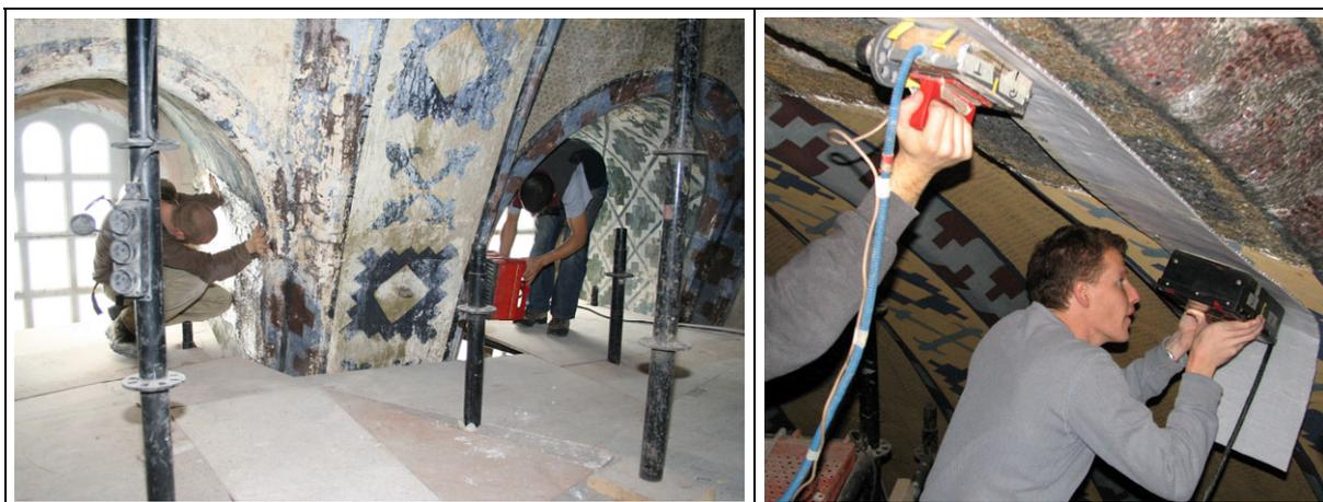
Abb. 4.5: (a) Radar-Reflexionsmessung an einem Fensterpfeiler
