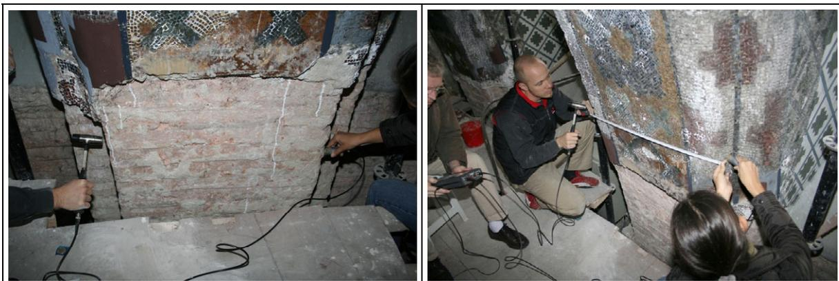
Abb. 4.6: (a) Transmissionsseismik am Mauerwerk und
