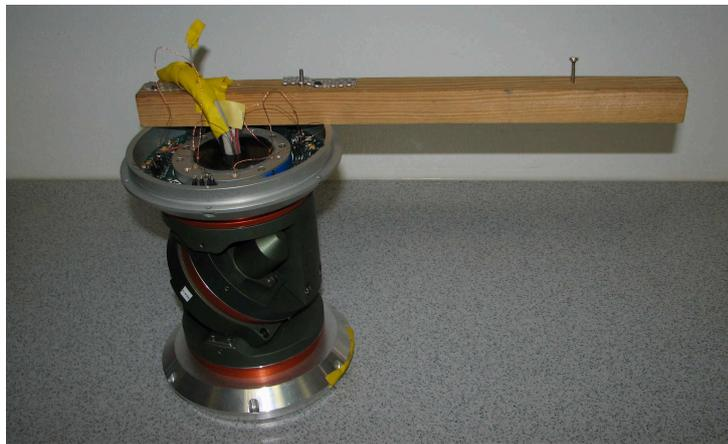
Abb. 7.9: Messaufbau: Knickelement mit Hebelarm.
