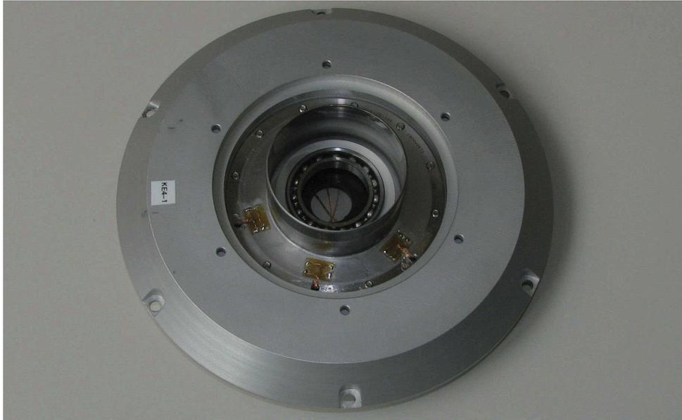
Abb. 6.9: Integration des Drehmoment-Sensors in KAIRO-II: Flanschplatte mit FLEXIBLE SPLINE und drei integrierten Dehnungsmessstreifen.
