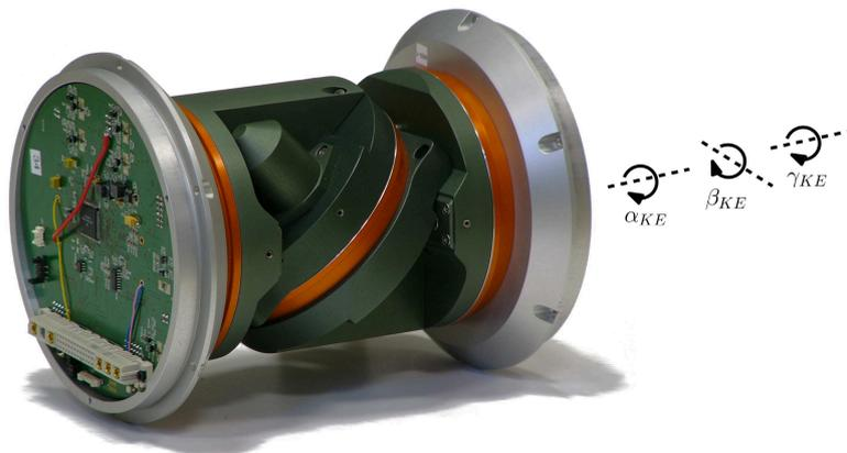
(c) Knickelement mit integrierter GAMMA-PLATINE (Bewegungsfreiheitsgrade (orange): Rotationen  $\alpha_{KE}$ ,  $\beta_{KE}$  und  $\gamma_{KE}$ ).
