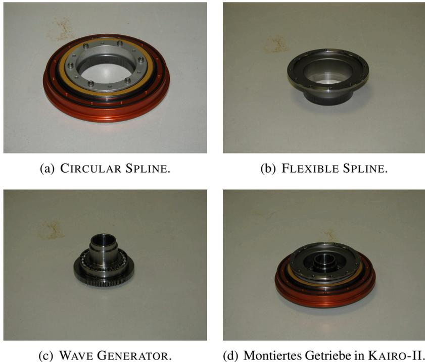
Abb. D.2: Bestandteile des HARMONIC DRIVE im KAIRO-II-Roboter.
