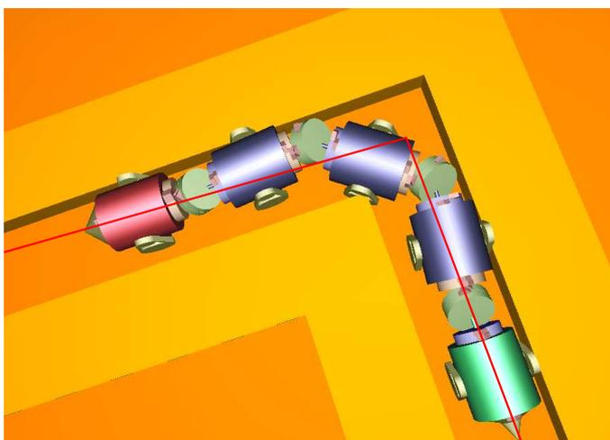
(a) 3D-Ansicht mit virtueller Schiene: Segment 3 verlässt zur Vermeidung von Verklemmungen deutlich die virtuelle Schiene.
