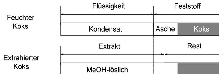
Abb. 52: Schematische Darstellung zur Korrektur des Ölgehalts feuchter Kondensatkokse.
