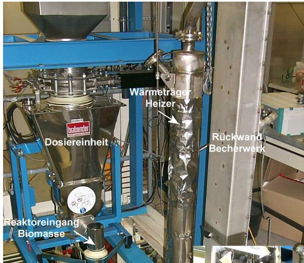
Abb. 47: Links im Bild: Unterer Teil der Biomasse-Dosiereinheit mit Ausgang, Mitte: Wärmeträger-Heizer, Rechts: Rückwand des Becherwerks.
